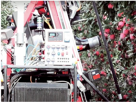
La disponibilidad de equipos de pulverización autónomos es un paso más hacia la automatización de tareas rutinarias en las explotaciones frutícolas como la protección del cultivo. En las fotografías las dos versiones propuestas por GUSS (California-USA) para baja (izda.) y alta densidad de plantación (dcha.). Fotos: GUSS, California-USA.
