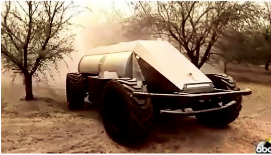
La disponibilidad de equipos de pulverización autónomos es un paso más hacia la automatización de tareas rutinarias en las explotaciones frutícolas como la protección del cultivo. En las fotografías las dos versiones propuestas por GUSS (California-USA) para baja (izda.) y alta densidad de plantación (dcha.). Fotos: GUSS, California-USA.
