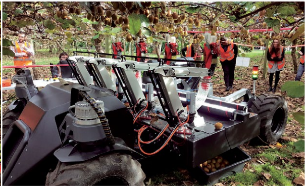
La recolección, por su alto requerimiento en mano de obra, ha sido la primera tarea objeto de robotización en manzana por varias empresas como Abundant Robotics (EE. UU.), FF Robotics (Foto: FF Robotics) y Tevel (Israel), de izda. a dcha., y de arriba abajo. Abajo dcha., recolección de kiwis por prototipo de Robotic Plus (Nueva Zelanda).
