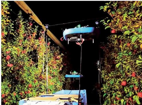
La recolección, por su alto requerimiento en mano de obra, ha sido la primera tarea objeto de robotización en manzana por varias empresas como Abundant Robotics (EE. UU.), FF Robotics (Foto: FF Robotics) y Tevel (Israel), de izda. a dcha., y de arriba abajo. Abajo dcha., recolección de kiwis por prototipo de Robotic Plus (Nueva Zelanda).
