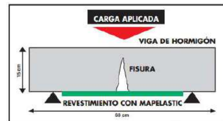
Fig. 1: Protección con Mapelastic de una fisura en el intradós de una viga de hormigón sometida a una tensión por flexión
