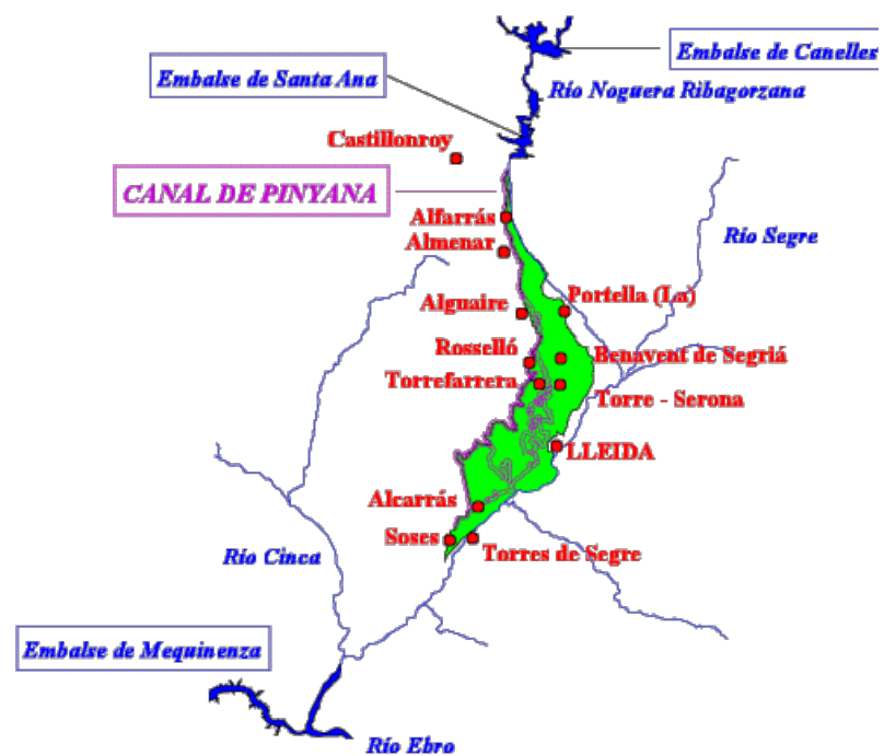
Figura 20. Reserves i zona regada del Canal de Pinyana. Font: CHE.
